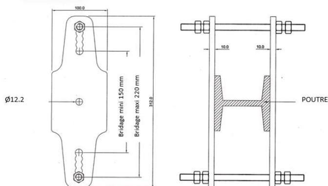
Conçue pour être fixée sur une poutre, par bridage, à la verticale et l'horizontale.
