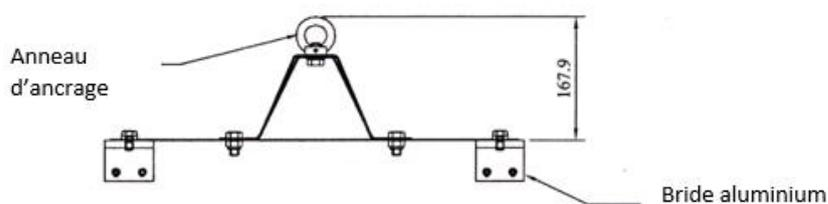
Fixation par brides en aluminium sur couverture à joint debout.
