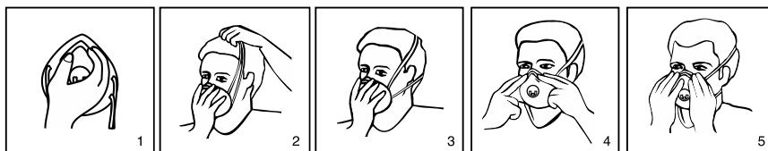
Durante l'uso della semimaschera, aumenta la resistenza respiratoria per il deposito di polvere. Se l'utente scopre che la resistenza è aumentata in modo significativo, la semimaschera deve essere sostituita con una nuova. La semimaschera non deve essere utilizzata per più di un turno lavorativo di 8 ore. In caso di utilizzo in atmosfera esplosiva, contattare Oxyline Sp. z o.o..
