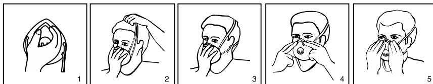
Bij gebruik van het ademhalingstoestel zal de ademweerstand toenemen door stofafzetting. Als de gebruiker constateert dat de ademhalingsweerstand aanzienlijk is toegenomen, moet het halfmasker worden vervangen. Het halfmasker mag niet langer dan door een werkdienst van 8 uur worden gebruikt. In geval van gebruik in een explosieve atmosfeer neem contact met Oxyline Sp. z.o.o. op.
