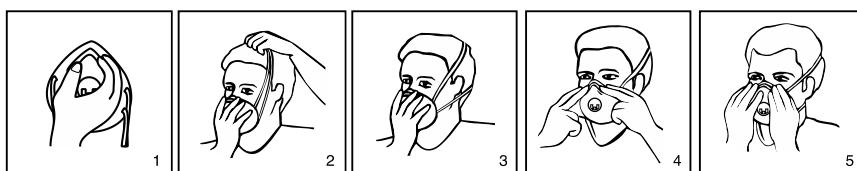
Während der Benutzung der Halbmaske kommt es zu einer Erhöhung des Atemwiderstands, die durch die Ablagerung von Staub auf der Maske verursacht wird. Wenn der Benutzer feststellt, dass der Widerstand erheblich zugenommen hat, ist die Halbmaske durch eine neue zu ersetzen. Die Halbmaske ist für die Verwendung während einer Schicht (max. 8 Std.) vorgesehen. Bei Verwendung in einer explosionsgefährdeten Atmosphäre wenden Sie sich an Oxyline Sp. z o.o.
