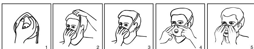
Počas používania polomasky sa zvyšuje dýchací odpor v dôsledku usadzovania prachu. Ak používateľ zistí, že sa odpor výrazne zvýšil, mal by polomasku vymeniť za novú. Polomaska sa nesmie používať dlhšie ako jednu 8-hodinovú pracovnú zmenu. V prípade použitia vo výbušnom prostredí kontaktujte Oxyline Sp. z o.o.
