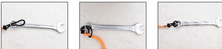
⇒ Fissare saldamente il nodo fatto come indicato in figura usando l'elemento di blocco presente sulla cordicella.
