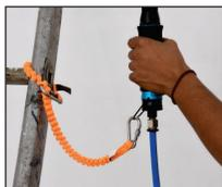
Vergewissern sie sich stets, dass die Verbinder (per Schraube) fest verriegelt und gesichert sind.
