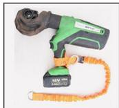
Met de ronde metalen ring op de gereedschaphouderlijn TS 90 001 01 kan het gereedschap aan het bevestigingselement dat aan de gebruiker is bevestigd, worden gehaakt terwijl het gereedschap niet in gebruik is.
