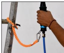
Toujours bien vérifier la fermeture et le verrouillage (à vis) des connecteurs.
