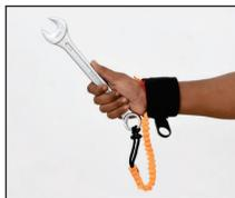
Überprüfen Sie stets das Haftvermögen des Klettverschlusses, denn er gewährleistet den sicheren Verschluss und die Festigkeit des Armbands bei Absturz eines Werkzeugs.
