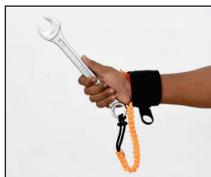
Compruebe siempre la calidad de enganche de los velcros, ya que estos garantizan el cierre correcto y la resistencia del brazalete en caso de caída de la herramienta.
