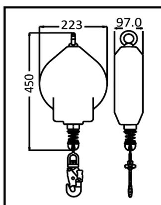
Antichute à rappel automatique de charge conçu pour arrêter la chute d'une charge maxi de 300Kg
