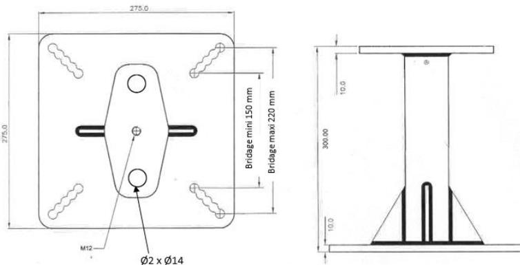
Potelet pour ligne de vie prévu pour être installé en point d'extrémité, en point intermédiaire ou en angle.
