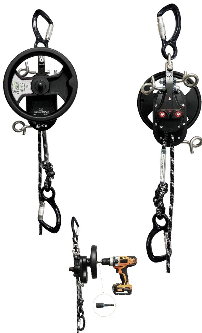
Ce dispositif est l'équipement idéal pour des opérations d'évacuation et de sauvetage rapides. Conçu en alliage d'aluminium et acier à haute résistance et équipé avec une corde semi - statique tressée de diamètre 9,6 mm assemblée au système. Extrémités de la corde avec doubles « nœuds de 8 » pour les connexions par l'intermédiaire de connecteurs. Fourni avec 2 connecteurs FA 50 220 21.
