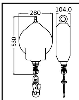
Antichute à rappel automatique de charge conçu pour arrêter la chute d'une charge maxi de 400Kg
