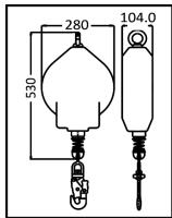
Antichute à rappel automatique de charge conçu pour arrêter la chute d'une charge maxi de 500 kg
