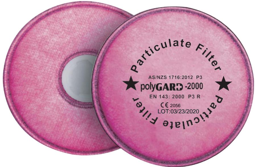
El filtro, cuando se coloca con una pieza facial adecuada de dos filtros (media máscara, máscara), protege el sistema respiratorio de aerosoles sólidos no tóxicos y de toxicidad media o aerosoles a base de agua (polvo, humo, niebla), si la concentración La fase dispersa del aerosol no excede los valores de 50 x OEL (Límites de exposición ocupacional) cuando se coloca con una media máscara y 1000 x OEL cuando se coloca con una máscara completa.
