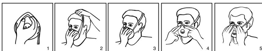
Während der Benutzung der Halbmaske kommt es zu einer Erhöhung des Atemwiderstands, die durch die Ablagerung von Staub auf der Maske verursacht wird. Wenn der Benutzer feststellt, dass der Widerstand erheblich zugenommen hat, ist die Halbmaske durch eine neue zu ersetzen. Die Halbmaske ist für die Verwendung während einer Schicht (max. 8 Std.) vorgesehen. Bei Verwendung in einer explosionsgefährdeten Atmosphäre wenden Sie sich an Oxyline Sp. z o.o.
