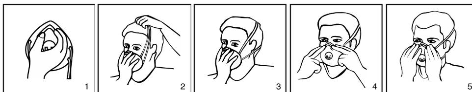
Während der Benutzung der Halbmaske kommt es zu einer Erhöhung des Atemwiderstands, die durch die Ablagerung von Staub auf der Maske verursacht wird. Wenn der Benutzer feststellt, dass der Widerstand erheblich zugenommen hat, ist die Halbmaske durch eine neue zu ersetzen. Die Halbmaske ist für die Verwendung während einer Schicht (max. 8 Std.) vorgesehen.
