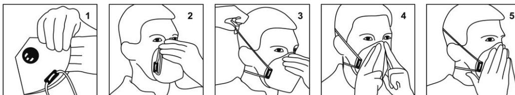
Lors de l'utilisation d'un demi-masque, il y a une augmentation de la résistance respiratoire causée par l'accumulation de poussière sur celui-ci. Si l'utilisateur constate que la résistance a augmenté de manière significative, un demi-masque utilisé doit être remplacé par un autre. Un demi-masque est conçu pour être utilisé pendant une journée de travail (8 heures maximum).
