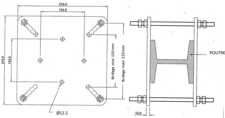
Conçue pour être fixée sur une poutre, par bridage, à la verticale et l'horizontale.
