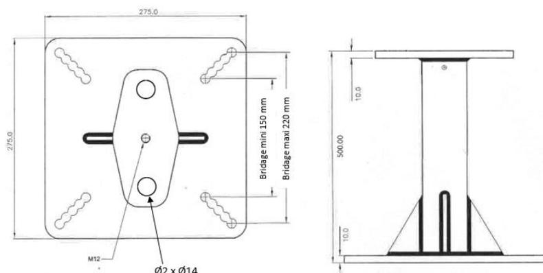
Potelet pour ligne de vie prévu pour être installé en point d'extrémité, en point intermédiaire ou en angle.
