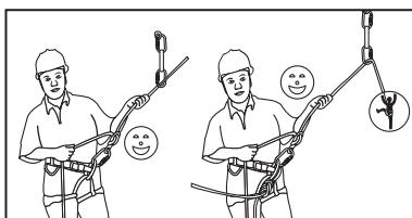
Per bloccare velocemente e facilmente la caduta di una persona occorre tenere saldamente la corda e mettere sempre la mano al di sotto del discensore.
