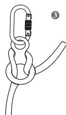
Freinage / Braking / Bremsen / Frenado / Remmen / Hamowanie / Travagem / Bremsning / Jarrutus / Bremsing / Bromsning / Zavorna / Frenleme
